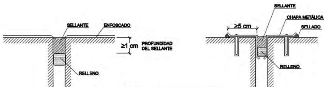
Figura 2.6 Ejemplos de juntas de dilatación
